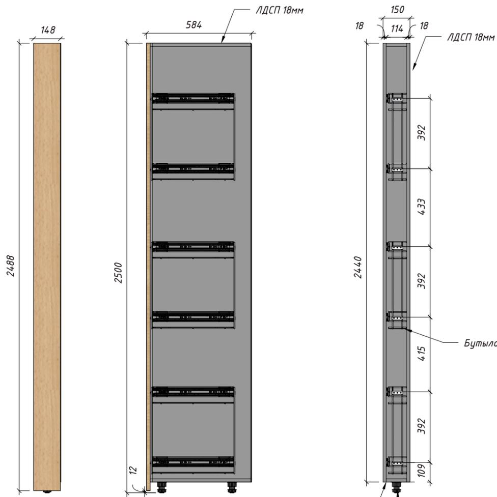
Разметку крепежа выполнить при сборке
